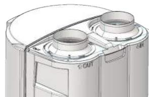
**3** Monter les adaptateurs de gainage en effectuant un mouvement de ¼ de tour dans le sens horaire.
