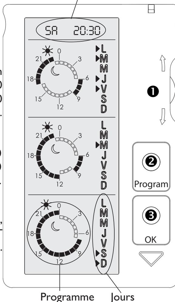
① Navigateur permettant le déplacement dans l'afficheur par mouvement vers le haut ou le bas.
