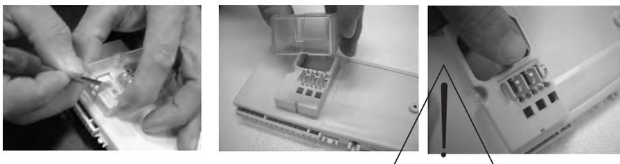
Ne pas déformer les lames de contact.
