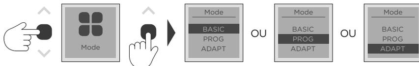
Le mode PROG permet la **programmation manuelle de l'appareil** et le mode ADAPT permet à l'appareil d'être en programmation manuelle **tout en s'adaptant en cas d'absence ou présence imprévue** à l'aide du détecteur.
