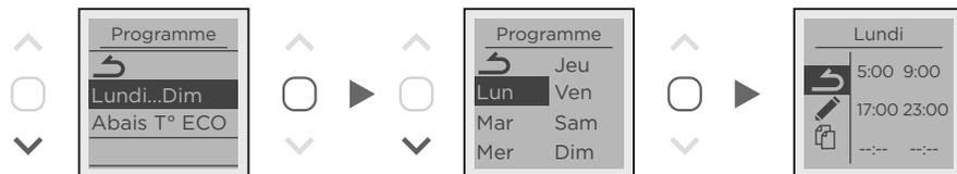
Vous pouvez programmer jusqu'à 3 plages de température « Confort » pour chaque jour de la semaine. En dehors de ces plages, l'appareil effectue un abaissement de température [réglé par défaut à  $-3,5^{\circ}\text{C}$ ].
