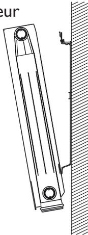
**2** Ramenez le radiateur vers la patte puis, en le relevant, introduisez la patte d'accrochage dans les 2 encoches prévues à cet effet.
