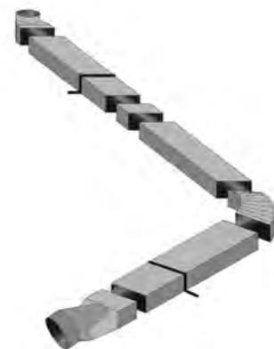
De la gaine polyéthylène peut également être utilisée dans cette configuration (y compris sur le rejet).
