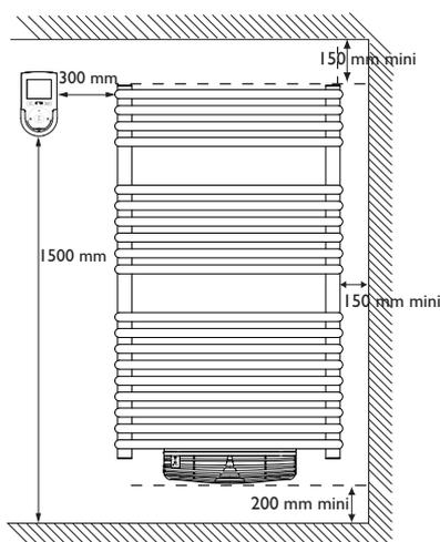
La distance de 300 mm entre l'appareil et la commande digitale est préconisée pour un fonctionnement optimal de votre appareil.
