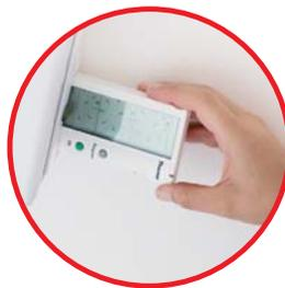
Insérez directement la carte, en bas au dos de l'appareil, dans l'interface de programmation.
