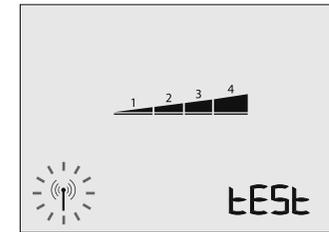
Si l'écran suivant apparaît, cela signifie qu'il n'y a pas de réception du signal par la commande.
