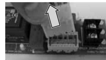
Débrancher le connecteur de l'élément chauffant
